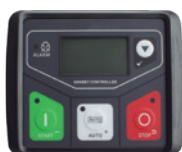
PANTALLA DC30 Lectura frecuencia, amperaje, Kw, horas y precalentador injetor.
