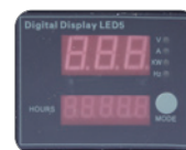
PANTALLA DIGITAL LED5 5 FUNCIONES (Cuenta horas, voltaje, frecuencia, amperaje y kW en consumo)
